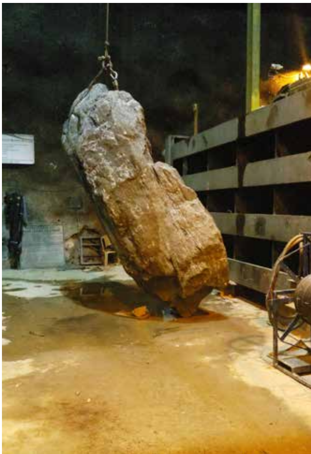
Figura 2. Proceso de extracción de la roca en una sola pieza con un peso aproximado de 27 toneladas. Fuente: DEBUS
