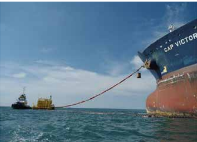
Figura 5. Buque tipo tanquero, efectuando trasiego de hidrocarburo. en una monoboya de Coveñas Fuente: DEBUS
