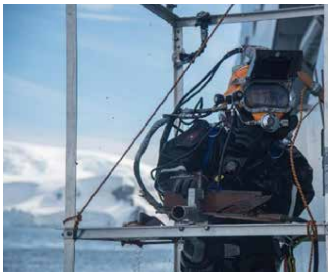
Figura 7. Buzo de la Armada de Colombia saliendo del agua tras realizar pruebas de soldadura submarina a 15 pies, en la antártica, como parte de uno de los proyectos de investigación desarrollados en la tercera expedición de Colombia a la Antártida. Fuente: GCOMES
