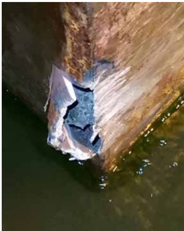
Figura 1. Avería en el espejo ARC “Juan Ricardo Oyola Vera” Fuente: DEBUS
