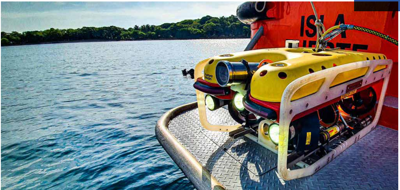
Prueba en superficie del equipo ROV, previo a una inmersión subacuática. Fuente: DEBUS
