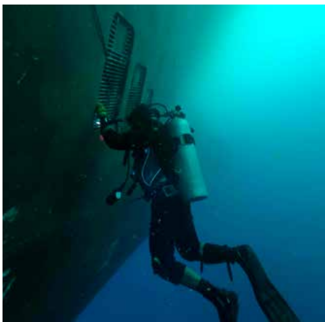
Figura 2. Buzo realizando inspección subacuática. Fuente: DEBUS
