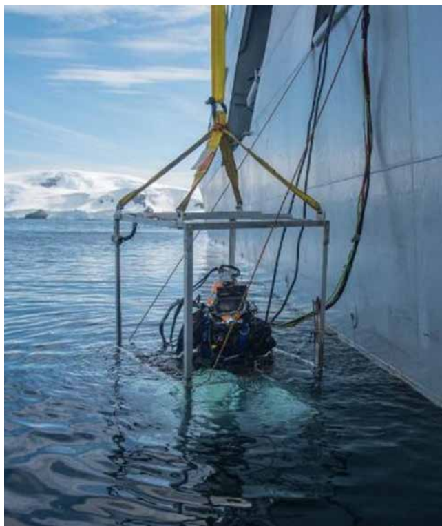
Figura 6. Buzo de la Armada de Colombia ingresando al agua para realizar pruebas de soldadura submarina a 15 pies en la península Antártica como parte de uno de los proyectos de investigación desarrollados en la tercera expedición de Colombia a la Antártida. Fuente: GCOMES
