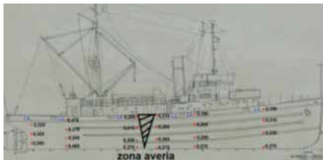
Figura 16. Puntos con datos medición de espesores. Fuente Departamento de Buceo y Salvamento Armada de Colombia.
