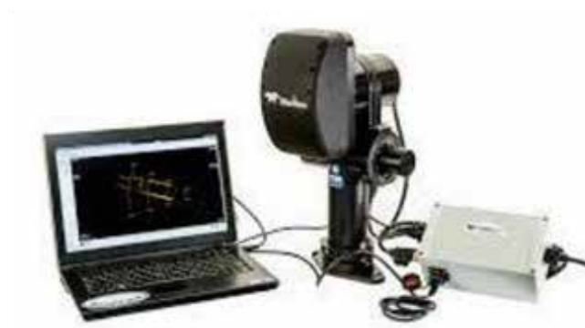
Figura 4. Sonar de escaneo mecánico para modelado 3D. Fuente: Manual sonar 3D BV500.
